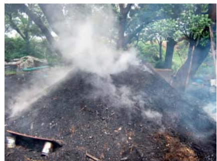
Figura 8. Proceso de transformación de la madera a carbón vegetal mediante quemado.
