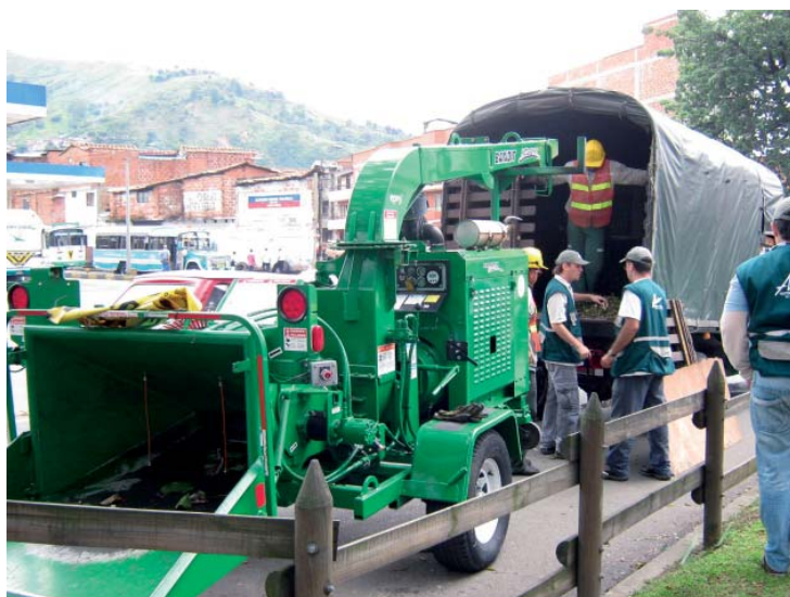
Figura 11. Máquina para picar productos vegetales, comúnmente llamada “chipeadora”. En esta guía se le llamará máquina picadora de material vegetal.
